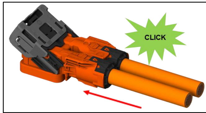
Fig. 3.7.8: Insert the retainer cap with max. 80N each Bild 3.7.8: Haltekappe mit je 80N max. aufschieben
