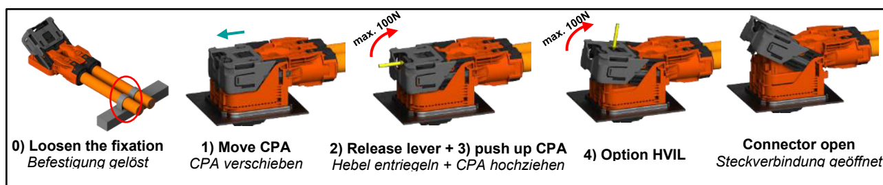
Fig. 5.4.8: Unlocking of the connector – summary Bild 5.4.8: Entriegelung des Steckverbinders Zusammenfassung
